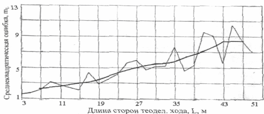
Рисунок 2- Зависимость среднеквадратической погрешности от размеров измеряемых величин.
