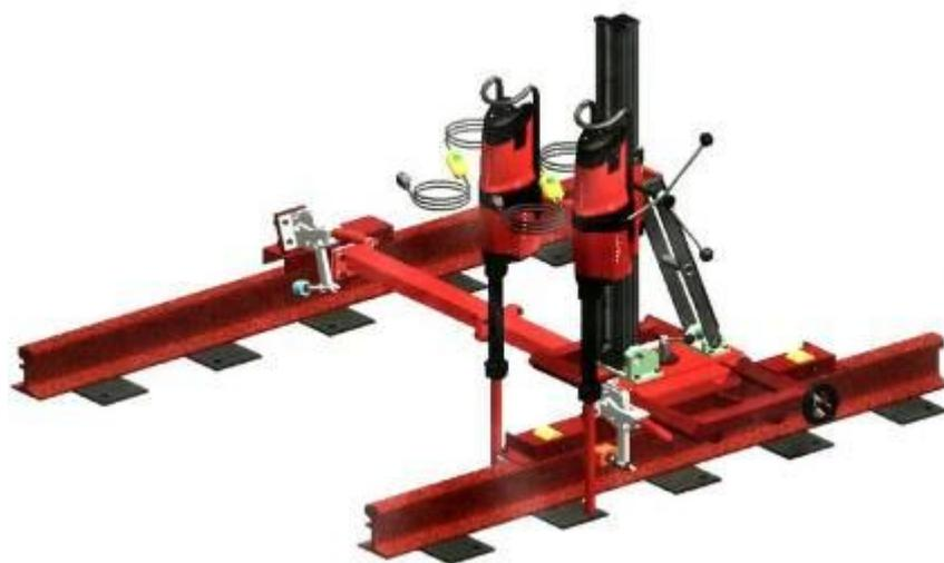
Рисунок 7 - Конструкция для сверления отверстий под анкера скреплений
