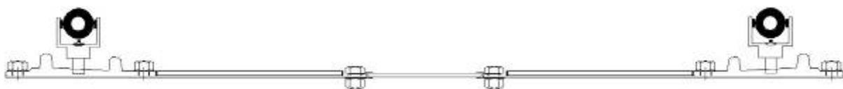
Рисунок 8 - Устройство геодезических отражателей на фальш-шпалах
