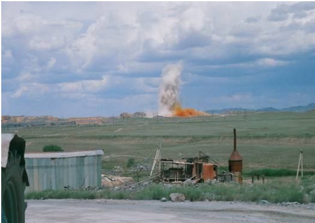
Сурет 10 – Ұңғымалық оқтаманың жарылысы, сол жақта жаңа әдіс бойынша- ақ түсті, ескі әдіс бойынша – қызыл түсті көрініс
