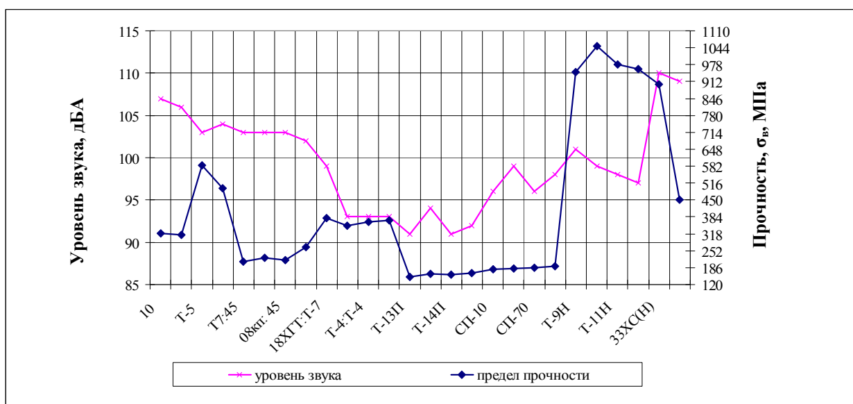
Рисунок 5 - Сравнительные характеристики уровней шума и предела прочности исследованных материалов.
